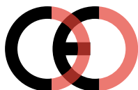
Falsche CE-Kennzeichnung (zu dicht)
